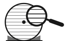
· Examiner les tourets s'il y ait des dommages
